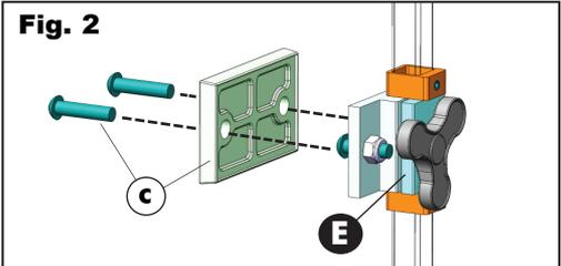
**Fig. 5 FLIP BACK LOCK/RELEASE MECHANISM**
